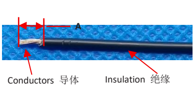
Signal cable 信号线
